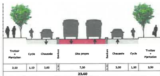
Figure 5 : Coupe type pour l'insertion d'un site propre bidirectionnel axial
