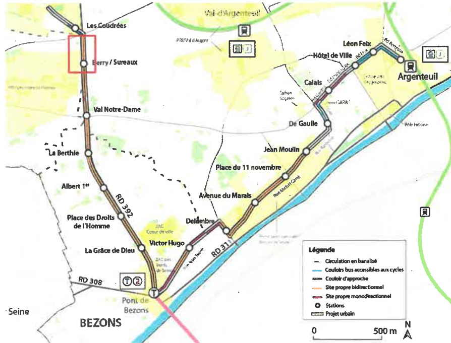
Figure 4 : Aménagements bus retenus sur les voies dédiées
